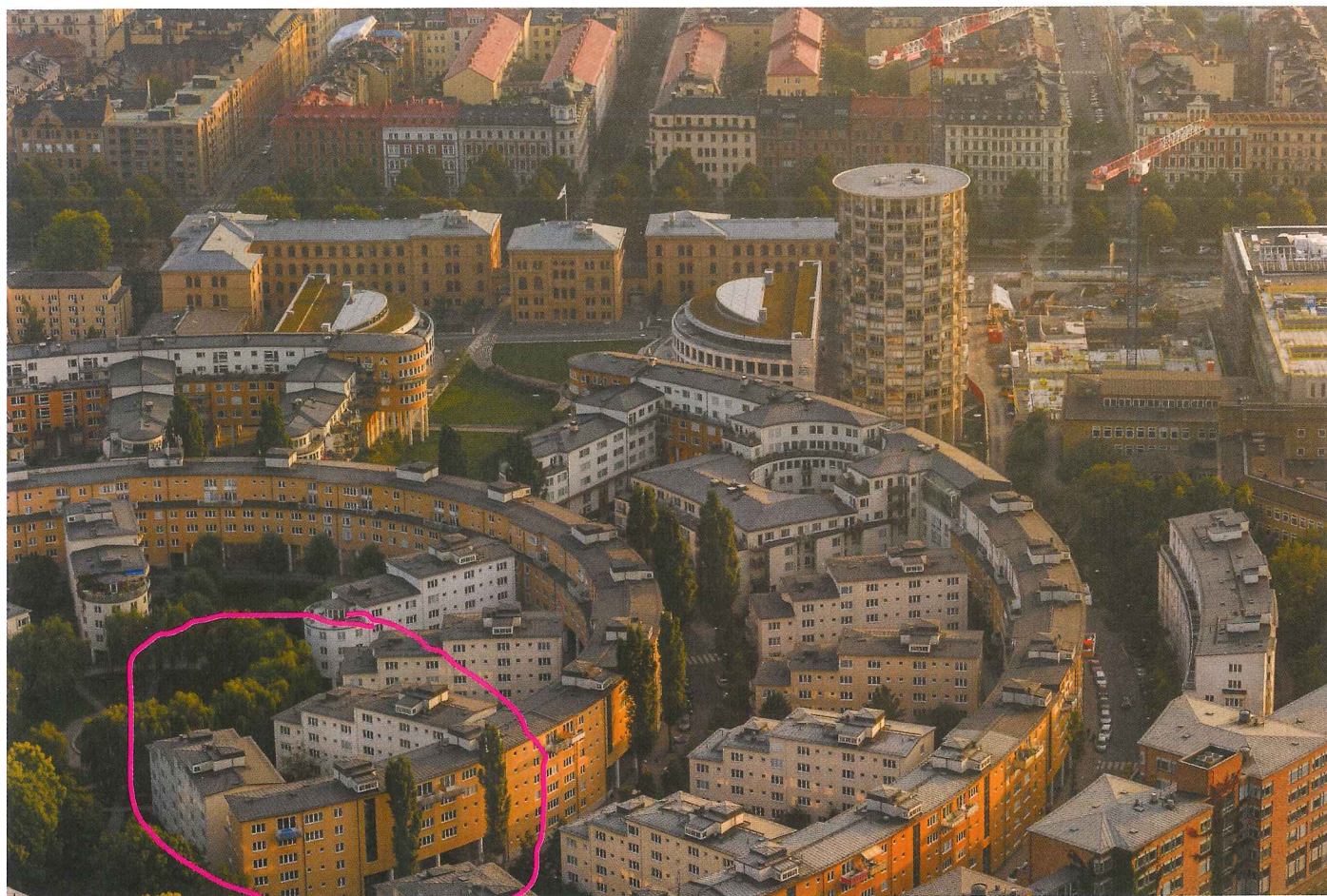
Brf Ekern i Stockholm, en av de nya föreningarna intill Svea Torn på Gärdet, har kompletterat den ursprungliga fjärrvärmerna med en kombination av bergvärme, frånluftspumpar och solceller och har sänkt energikostnaden från 1,5 miljoner till 350.000 kr per år. Foto: Wikimedia
